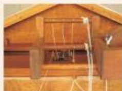
Ο μηχανισμός χρονισμού για την αλλαγή των σκηνικών Tuning mechanism for the change of scenery
