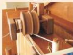
Ο μηχανισμός χρονισμού για τον περίπλου των πλοίων, την κίνηση της Αθήνας και το άναμμα του πυρσού Tuning mechanism for the circumnavigation of the ships, movement of Athens and the lighting of the torch
