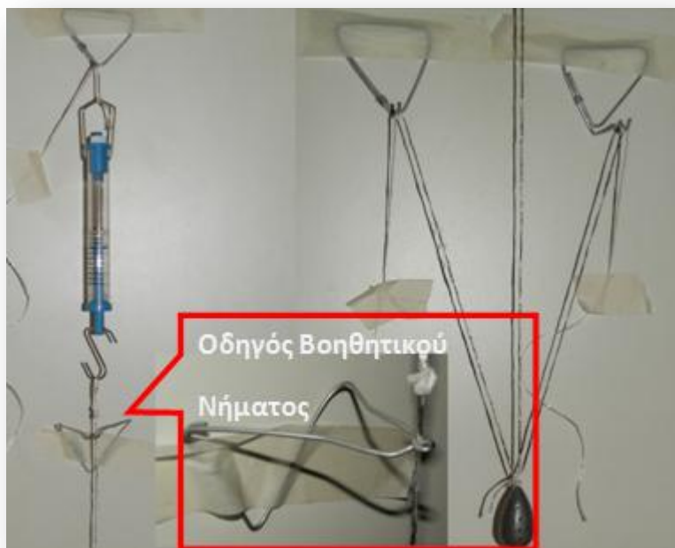
Εικόνα 4. Προσομοίωση βαρύτητας μικρότερης της κανονικής. Στο ένθετο φαίνεται η λεπτομέρεια του οδηγού του βοηθητικού νήματος κοντά στο δυναμόμετρο.
