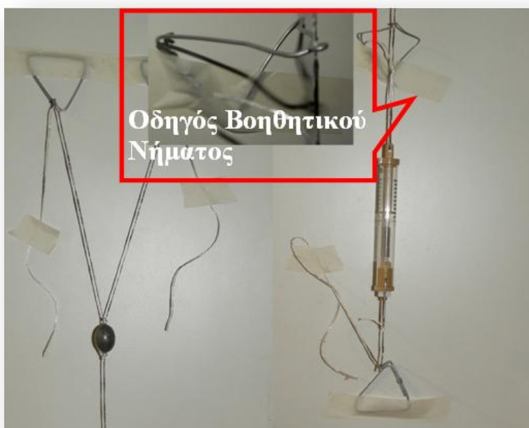
Εικόνα 3. Προσομοίωση βαρύτητας μεγαλύτερης της κανονικής. Στο ένθετο φαίνεται η λεπτομέρεια του οδηγού του βοηθητικού νήματος κοντά στο δυναμόμετρο.
