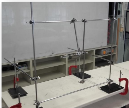
Εικόνα 7. Μηχανικό ανάλογο λυγισμένου και τεντωμένου ποδιού με μεταλλικές ράβδους
