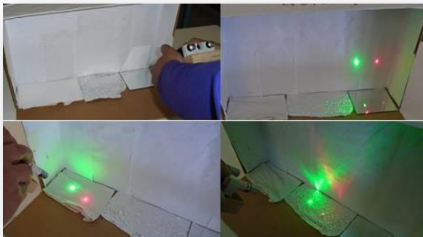
Εικόνα 4. Ανάκλαση σε καθρέπτη, διάχυση σε χαρτοπετσέτα και αλουμινόχαρτο
