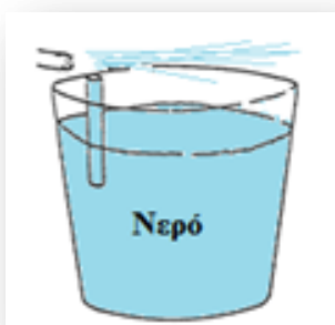
Εικόνα 11. Φυσώντας με το οριζόντιο καλαμάκι βγαίνει νερό από το κατακόρυφο
