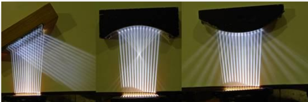
Εικόνα 13: Παράλληλες ακτίνες σε επίπεδο, κοίλο και κυρτό καθρέπτη
