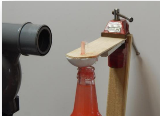
Εικόνα 13. Όταν η άκρη του λεπτού διαφανούς σωλήνα περνά πάνω από την οριζόντια επιφάνεια παρατηρείται ψεκάσμος
