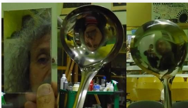
Εικόνα 9. Είδωλο και οπτικό πεδίο σε επίπεδο, κοίλο και κυρτό καθρέπτη
