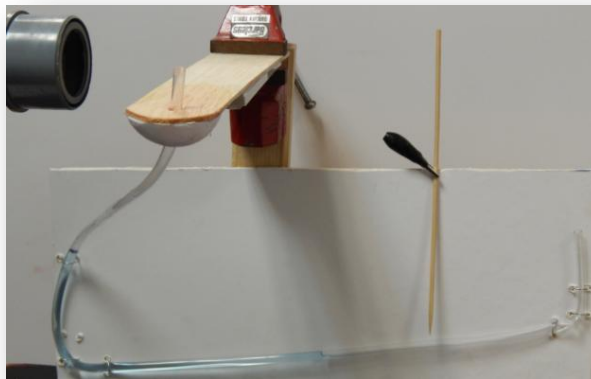
Εικόνα 14. Όταν η άκρη του λεπτού διαφανούς σωλήνα περνά πάνω από την οριζόντια επιφάνεια παρατηρείται μετακίνηση του νερού στο μανόμετρο
