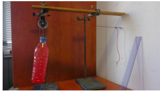
Εικόνα 2α (αριστερά). Ένα ελατήριο επιμηκύνεται εξαιτίας των δυνάμεων που ασκούν δύο όμοια αντικείμενα. Εικόνα 2β (δεξιά). Το δεύτερο αντικείμενο έχει απομακρυνθεί και το αντίστοιχο άκρο του νήματος έχει στερεωθεί σε ακλόνητο τοίχο. Η επιμήκυνση του ελατηρίου είναι ίδια και στις δύο περιπτώσεις (φωτογραφία του συγγραφέα).
