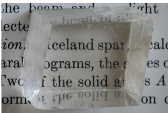
Εικόνα 4: Μόνο η τακτική ακτίνα είναι ορατή, όπως αντιλαμβανόμαστε από το γεγονός ότι δεν υπάρχει εκτροπή και βλέπουμε τα γράμματα πίσω από το δείγμα στο ίδιο επίπεδο με τα υπόλοιπα γράμματα. Το χαρακτηριστικό επίπεδο του αναλύτη σχηματίζει γωνία περίπου 0^{\circ} με τον οπτικό άξονα του δείγματος. (Φωτογραφία του συγγραφέα)
