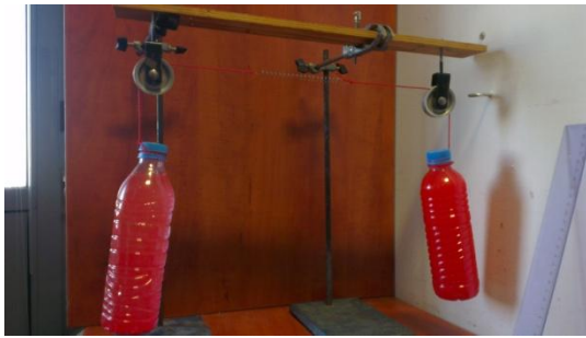
Εικόνα 2α (αριστερά). Ένα ελατήριο επιμηκύνεται εξαιτίας των δυνάμεων που ασκούν δύο όμοια αντικείμενα. Εικόνα 2β (δεξιά). Το δεύτερο αντικείμενο έχει απομακρυνθεί και το αντίστοιχο άκρο του νήματος έχει στερεωθεί σε ακλόνητο τοίχο. Η επιμήκυνση του ελατηρίου είναι ίδια και στις δύο περιπτώσεις (φωτογραφία του συγγραφέα).
