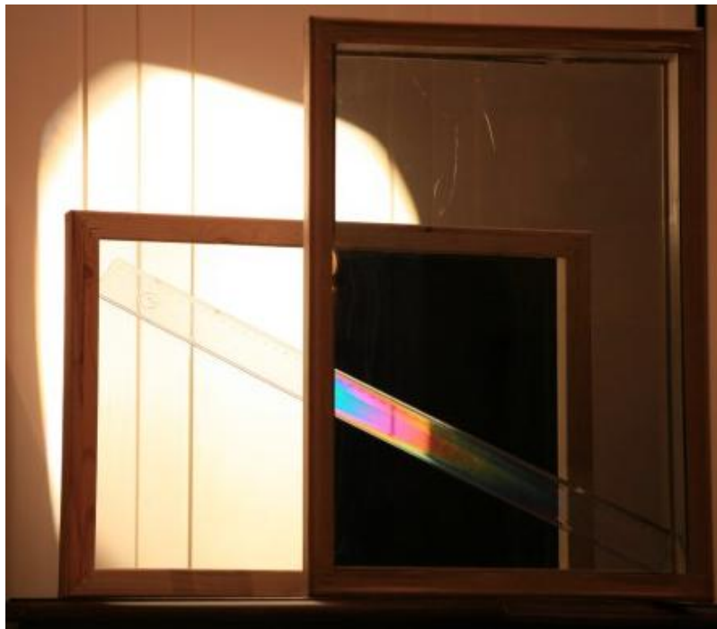
Εικόνα 6: Το πολωσιοσκόπιο. Τα δύο φύλλα Polaroid στα ξύλινα πλαίσιά τους και ένας πλαστικός χάρακας διαγώνια τοποθετημένος ανάμεσά τους. Στη συγκεκριμένη θέση τα δύο φύλλα έχουν τα χαρακτηριστικά τους επίπεδα κάθετα μεταξύ τους (πολωσιοσκόπιο σκοτεινού πεδίου). Διακρίνονται οι έγχρωμες ζώνες στον χάρακα. (Φωτογραφία του συγγραφέα)
