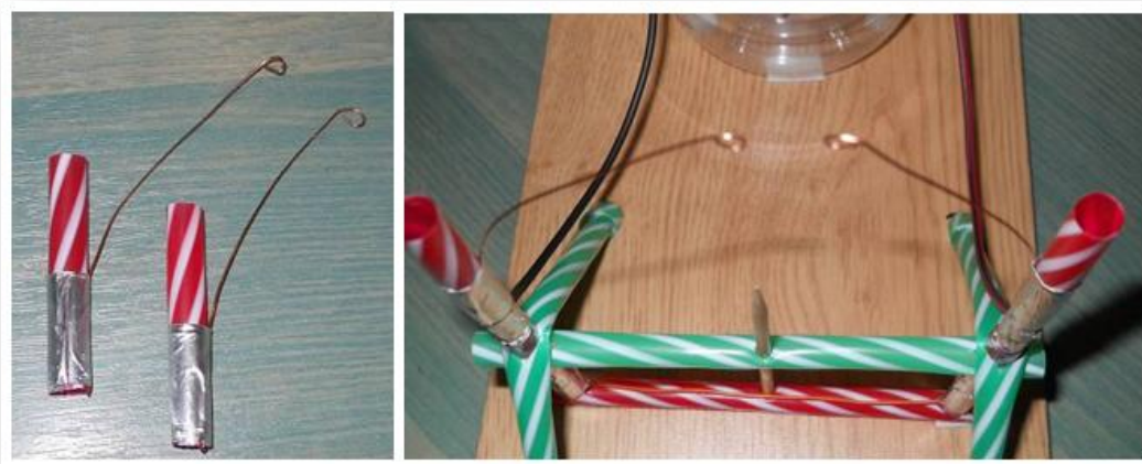
Εικόνα 10. α. (αριστερά) οι σπινθηριστές. β. τοποθετημένοι στους πυκνωτές.
