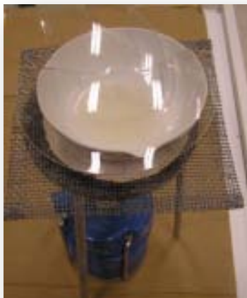
Εικόνα 1. Το ατύχημα κατά την θέρμανση του διηθήματος στην κάψα: η ύαλος έσπασε. (Φωτογραφία της συγγραφέα).
