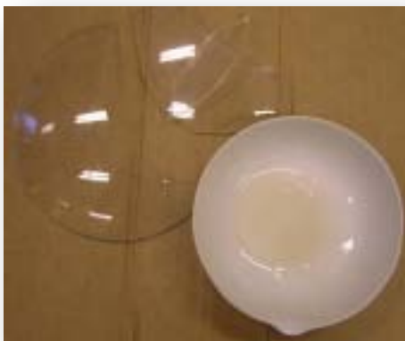
Εικόνα 1. Το ατύχημα κατά την θέρμανση του διηθήματος στην κάψα: η ύαλος έσπασε. (Φωτογραφία της συγγραφέα).
