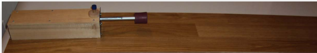
Εικόνα 1. Συσκευή (μηχανισμός) εκτίναξης αντικειμένων. (Φωτογραφία Φ. Ευαγγέλου).
