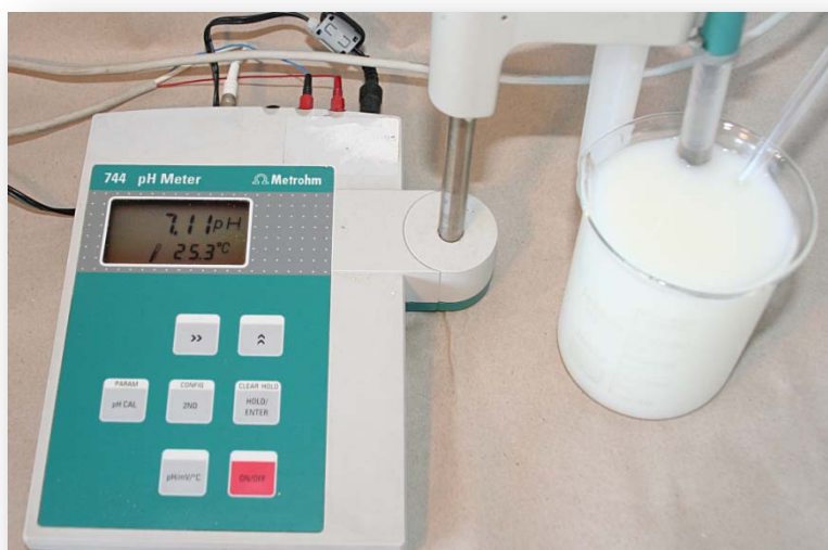
Εικόνα 3. Η καζεΐνη επαναδιαλυτοποιείται σε pH διαφορετικό από το ισοηλεκτρικό σημείο. Φωτογραφία Μ. Ξαπλαντέρη.
