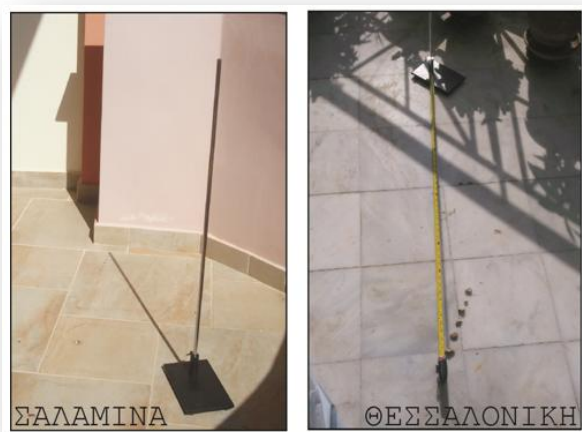
Εικόνα 3. Μετρώντας τη μεταβολή του μήκους της σκιάς στη Σαλαμίνα (αριστερά) και ταυτόχρονα στη Θεσσαλονίκη (δεξιά).
