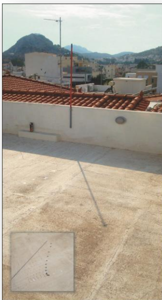
Εικόνα 8. Μέτρηση της σκιάς ράβδου κατά τη διάρκεια ενός έτους.
