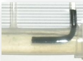
Εικόνα 5. Διαμόρφωση του άκρου του σωλήνα.
